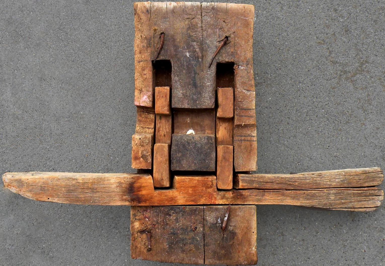
Serrure à coulisseaux ouverte montrant l'intérieur du boîtier avec les coulisseaux abaissés en position de verrouillage (Braux).
